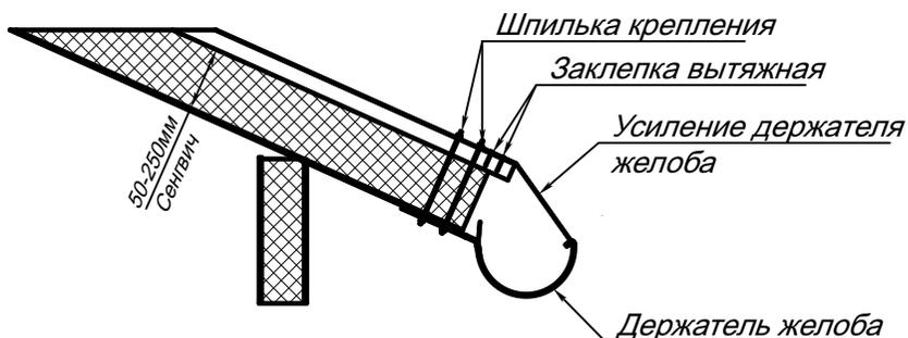
4) Обрезать лишнюю длину Усилителя держателя желоба, разметить и просверлить 2 отверстия под крепление клепками. Места крепления клепок рекомендуется расположить не ближе 20мм к свесу кровли. Минимальная длина прилегания Усилителя держателя желоба на волну кровли - 50мм.
